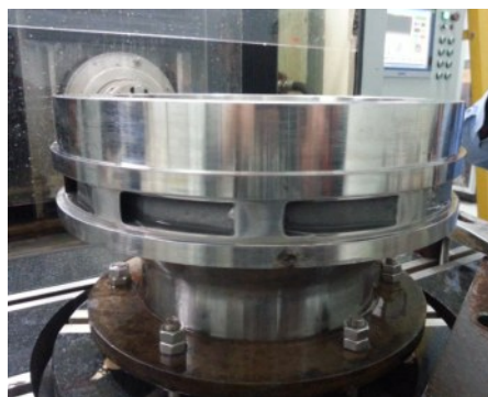
图5 完成腔体加工的样件
