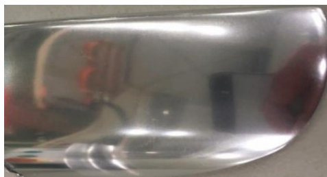
图1 G080202 样品耐碱 pH 13.5 测试后表面状态
