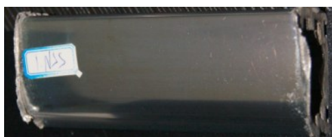
(a) NSS实验240 h测试后表面状态
