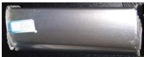
(b) NSS实验480 h测试后表面状态
