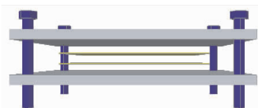
图1 湿热箱中的叠片装置示意图
