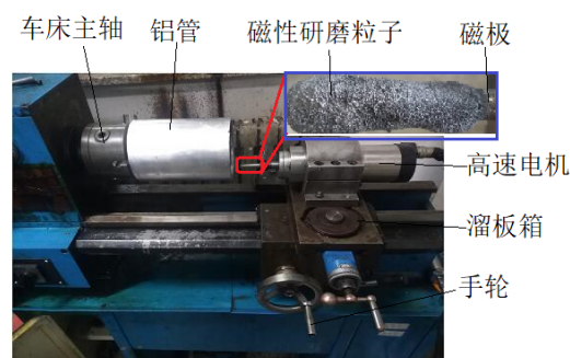
图1 磁粒研磨轴承内圈加工装置图
