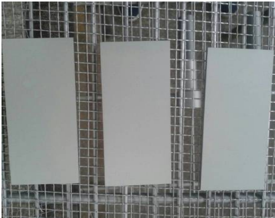
图 3 封闭后试片宏观形貌
