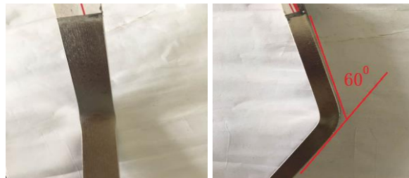
图3 Ni-W-P合金镀层结合力测试
