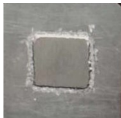
图14 涂层盐雾试验样件
