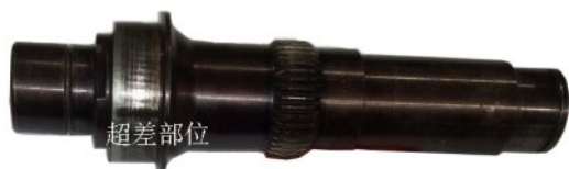
图1 尺寸超差的油泵轴
