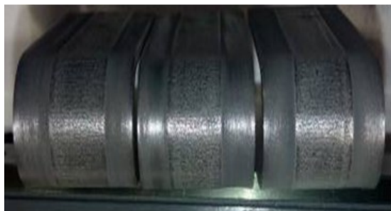
图11 涂层弯曲后形貌
