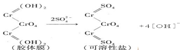
图2 \text{SO}_4^{2-} 对碱式铬酸铬胶体膜的溶解反应
