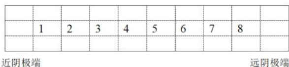
图2 测试镀液分散能力
