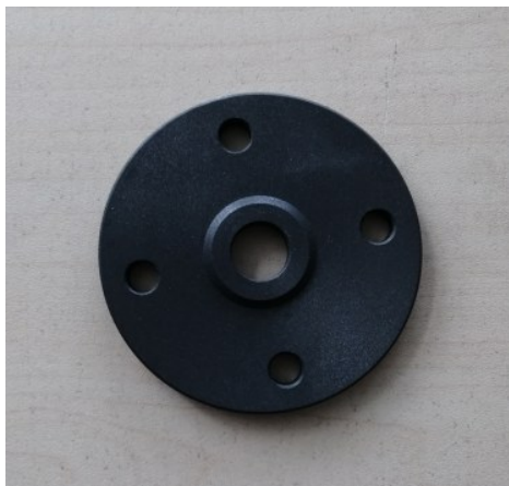
图1 磷化处理后法兰的宏观形貌
