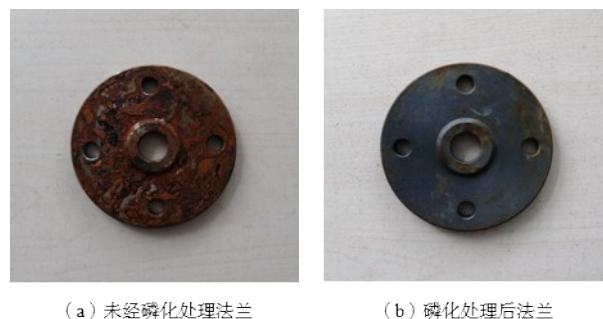
图4 48 h盐雾试验后的宏观形貌
