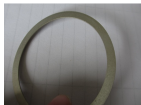
图6 故障槽液处理后试镀试片
