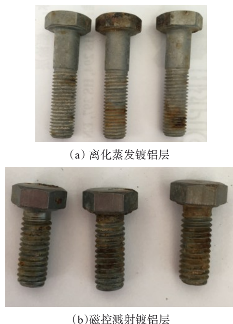
图3 铝镀层经 2000 h ASS 试验后外观
