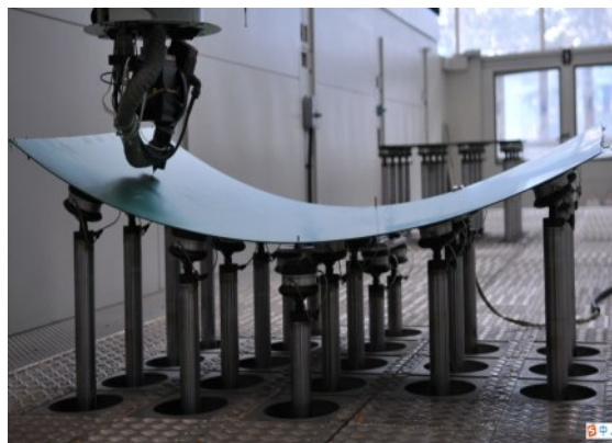
图4 柔性工装示意图
