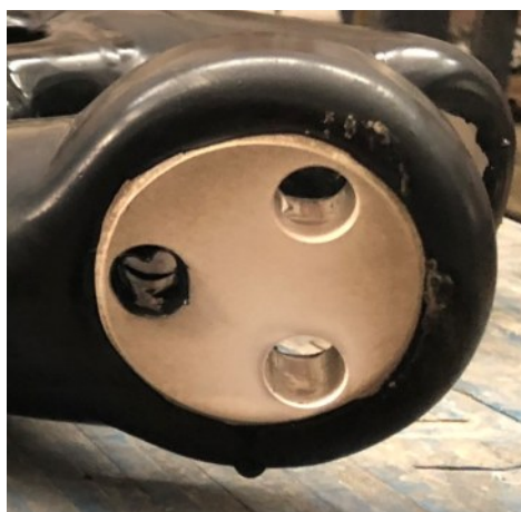
图4 降低电流密度电镀后零件镀层形貌
