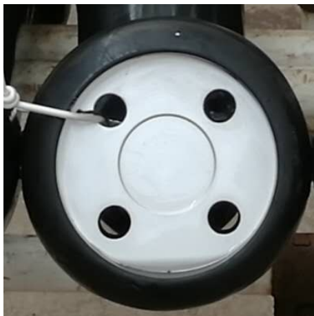
图 5 镀液加入碱性试剂后零件快速镀银的镀层形貌
