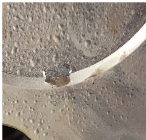
图 3 起泡镀层的切割图
