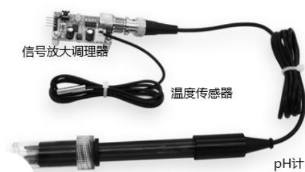
图3 带有温度测量的在线pH计
