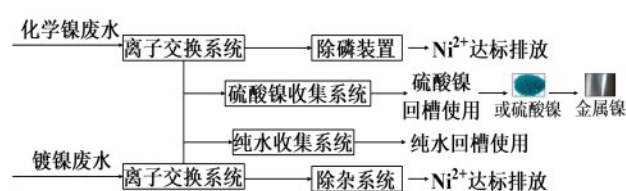
图1 离子交换法资源化回收含镍废水工艺流程
