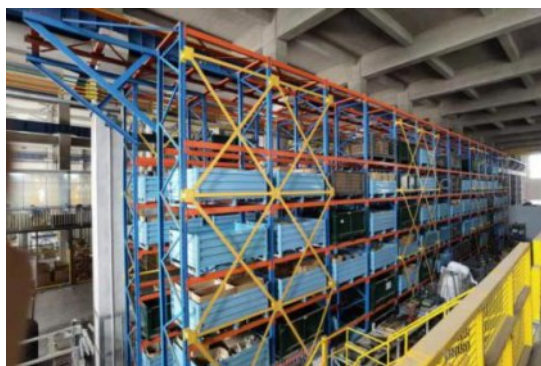
图3 电镀设备零部件自动化立体仓库
