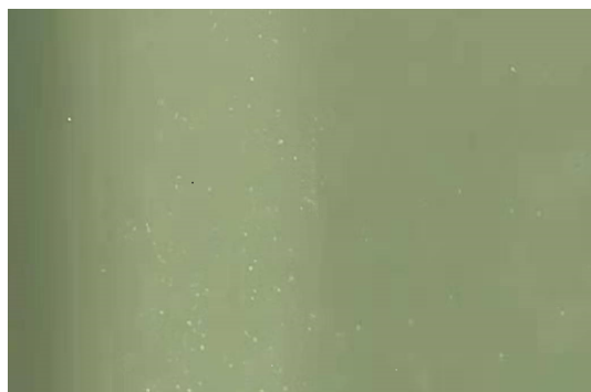
图1 粗糙电镀层形成的凸起颗粒
