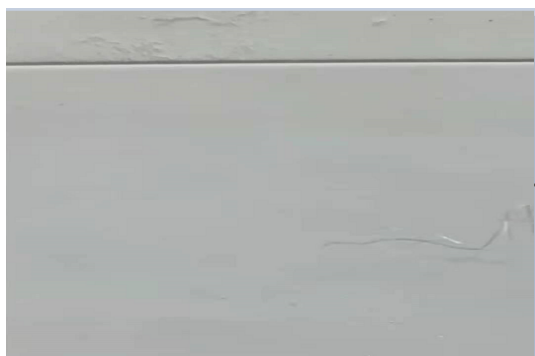
图3 喷涂在表面的环境浮尘和毛絮
