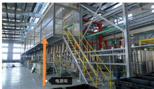
图11 直流电源封闭间
