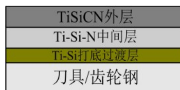
图1 涂层的结构示意图
