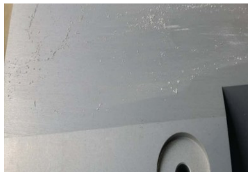
图 1 壳体零件表面出现的白色粉末照片
