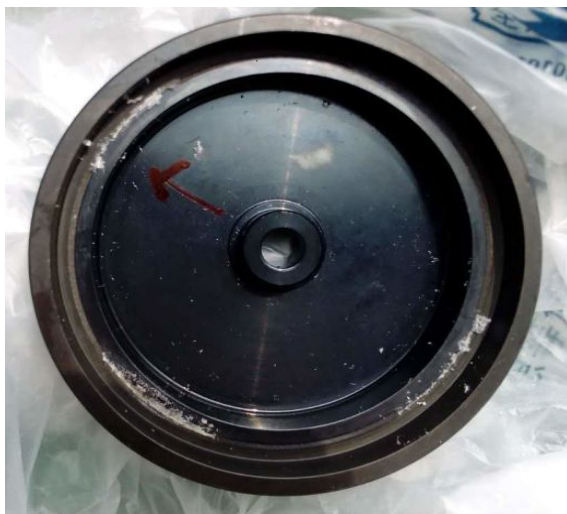
图3 极靴组件发蓝后白色结晶物析出
