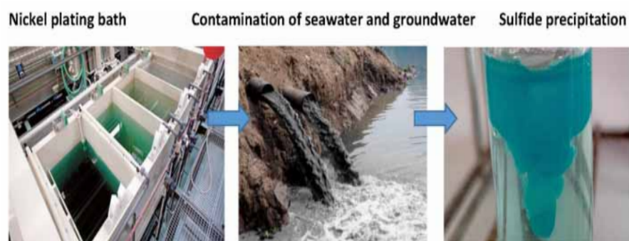
图4 硫化沉淀法去除镍及电镀废水污泥示意图 [31]
