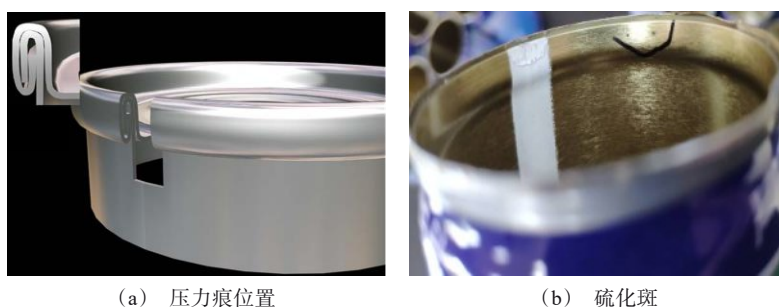
图 1 二重卷封的压力痕及硫化黑斑
