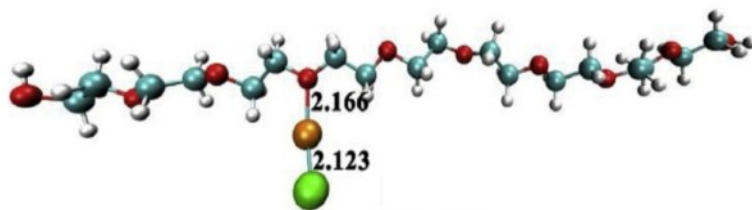
图6 PEG-Cu-Cl - 络合物在50 °C下的结构示意图 [55]
