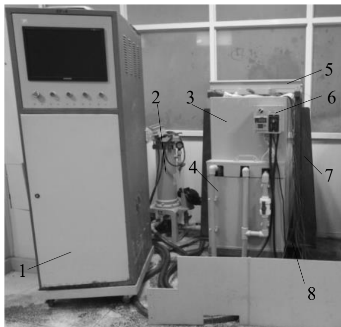
1.—控制柜; 2.—磁力泵过滤机; 3.—电铸工作槽; 4.—储液槽; 5.—悬挂齿轮架; 6.—控制盒; 7.—支架; 8.—平动工作台
