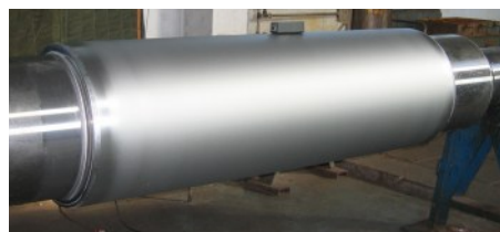
图 7 冷轧工作辊镀铬后表面形貌
