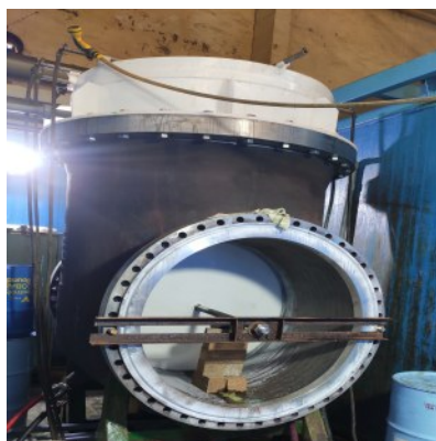
图8 阀体电镀照片
