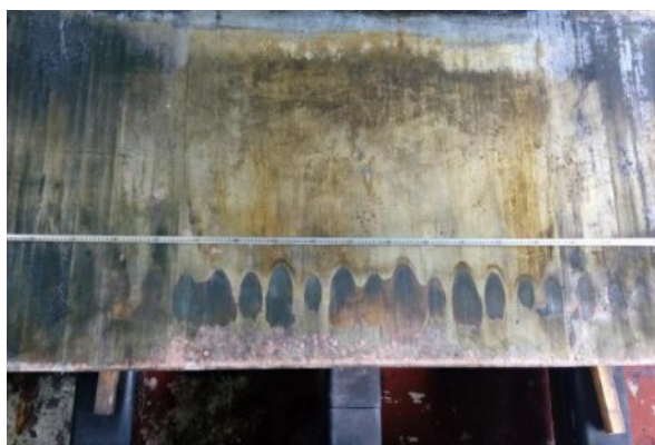
图 1 结晶器铜板腐蚀、磨损失效照片
