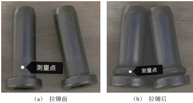
图6 拉铆前后产品变化
