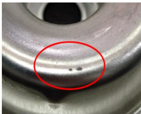
图1 气雾阀表面黑点缺陷宏观形貌
