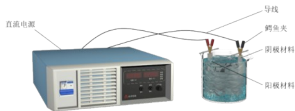
图 1 不锈钢电解抛光装置图
