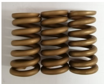
图1 离子镀铝弹簧宏观形貌
