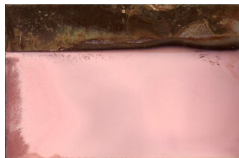
图3 一价铜镀液在2.0 A下得到的赫尔槽试片
