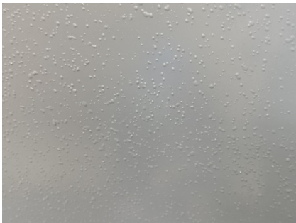
图4 压路机零部件洒点喷涂效果 Fig.4 Sprinkling effect of roller parts
