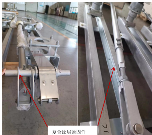
图 11 电镀锌镍/有机富铝复合涂层紧固件在高压交流隔离开关的应用
