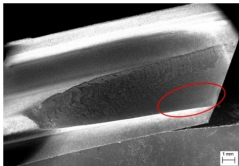
图3 轮齿折断起始位置
