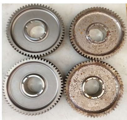
图7 锈蚀缺陷齿轮及完好齿轮
