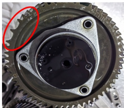
图1 轮齿折断失效模式
