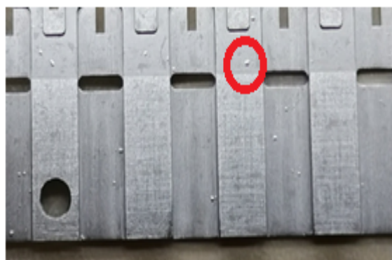
图3 零件基体上的鼓包形貌
