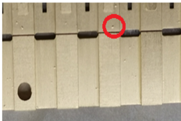
图1 有鼓包问题的零件
