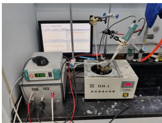
图6 三电极体系实验装置实物搭建图
