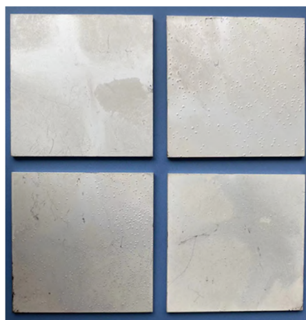
图 2 铝合金无氰哑光镀银试片热震后产生鼓泡
