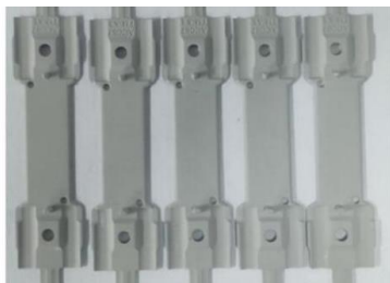
图5 微弧氧化膜层盐雾测试前外观图
