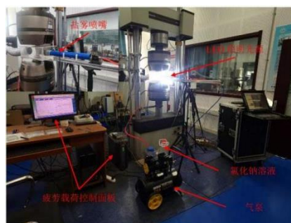
(b) 盐雾腐蚀疲劳平台操作台
