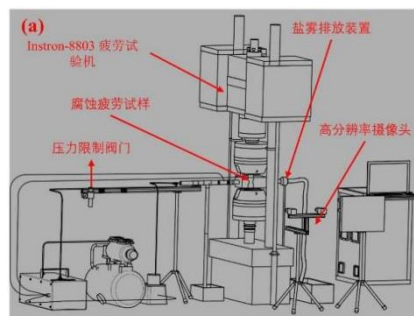
(a) 盐雾腐蚀疲劳平台理论图
