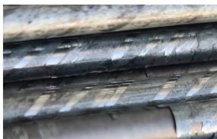
图3 热镀锌丝表面严重的螺旋状压痕
