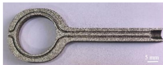
图 3 CoCrMo 高温合金燃油喷嘴二维构件实物图
