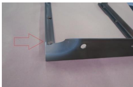
图1 支架的尖端烧损
