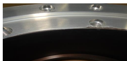
图 15 二次硬质阳极氧化零件细节图
