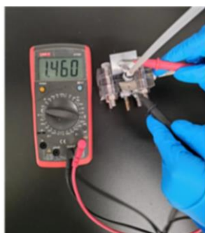
图10 万用表测 HPCo-N-C 基锌空气电池的开路电压
